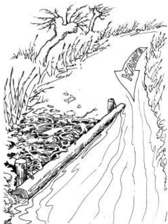
figuur 13. Doordat het bovenstroomse eind van de vuilvang aan een paaltje in de watergang is gehangen blijft er ruimte vrij voor kano's om te passeren.
