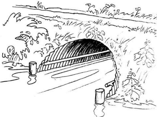
figuur 9. Een kanoduiker van gegalvaniseerd staal onder een landweg.
