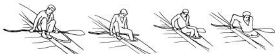
figuur 2. Bij het in- en uitstappen bij een kanovlot of -steiger wordt meestal de peddel als steun gebruikt. Daarom zijn steigers en vloten minstens een meter breed.
